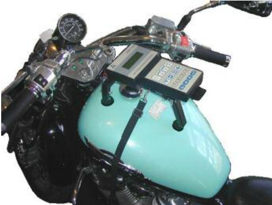
Bild 6 Funktionsgerecht auf dem Motorrad montiertes Gerät AMX520/M.
